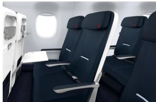
Die aus Kohlefaser und Titan gefertigte Sitzstruktur ist ultraleicht und äußerst stabil. Sie besteht aus recycelten Komponenten und enthält so wenig Kunststoff wie möglich. Jeder neue Sitz ist 30 Prozent leichter als das aktuelle Modell und trägt dazu bei, das Gesamtgewicht des Flugzeugs zu reduzieren, um den Treibstoffverbrauch und die CO<sub>2</sub>-Emissionen zu senken. Diese Initiative ist Teil der Strategie von Air France zur Verringerung der CO<sub>2</sub>-Emissionen,
